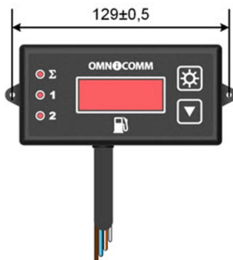
При монтаже индикатора Omnicomm LLD с помощью саморезов просверлите два крепежных отверстия Ø2,5 мм согласно установочным размерам.
